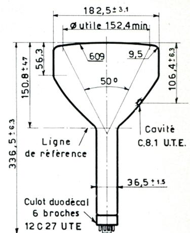
La ligne de référence est déterminée par le plan AB de la bague S 20220 lorsqu'elle vient buter sur le raccordement col bulbe.
